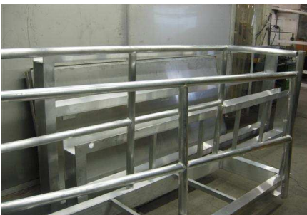
Die Geländerrohre werden verschweisst
