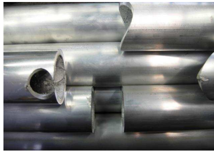
Mit dem Laser ausgesattelte Rohre
