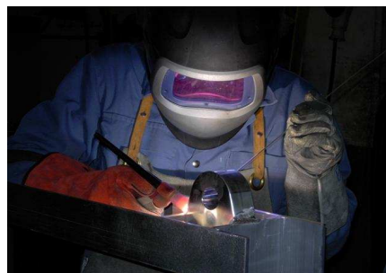
Die Rahmen und Aufhängungen werden angeschweisst
