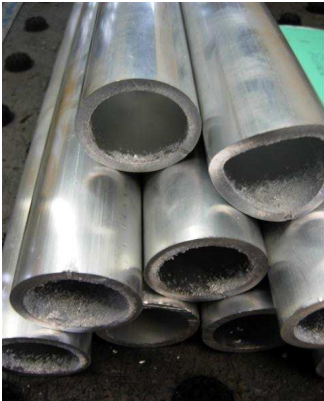
Mit dem Laser ausgesattelte Rohre
