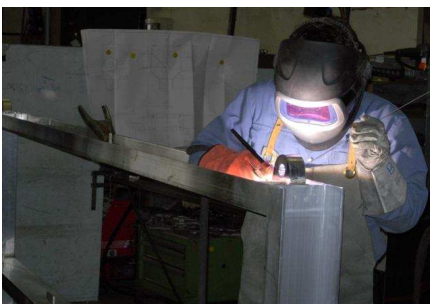
Die Rahmen und Aufhängungen werden angeschweisst
